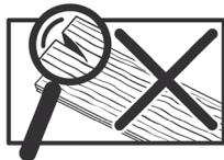
O revestimento do pavimento deve ser examinado antes da instalação para detetar quaisquer defeitos visíveis. Os pavimentos devem ser do mesmo lote de produção. Se existirem defeitos visíveis, notificar a GERFLOR e não iniciar a instalação sem a sua aprovação prévia.
